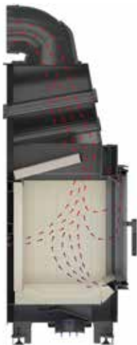
Rysunek 14. Schemat obiegu powietrza wewn trz wkładów z serii MB.
