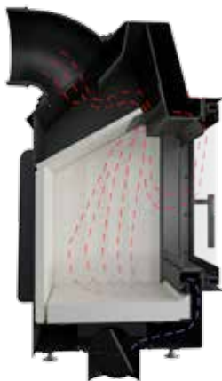
Rysunek 20. Schemat obiegu powietrza wewn trz wkładów ZIBI
