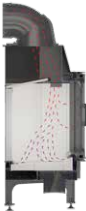
Rysunek 2. Schemat obiegu powietrza wewn trz wkładów z serii NADIA.
